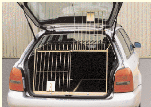
Durch das hohe Kantholz vorne, können die Türen der Autobox auch bei erhöhter Ladekante, wie zum Beispiel bei Audi A4 Avant, geöffnet werden.
